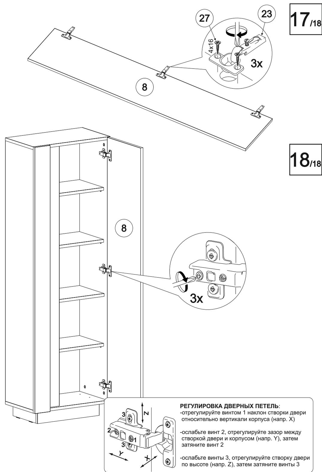
**РЕГУЛИРОВКА ДВЕРНЫХ ПЕТЕЛЬ:**
