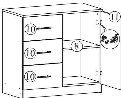
Отверстия под ручки досверлить сверлом D5.
